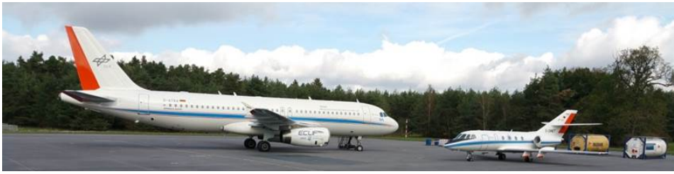
Abbildung 5.1 Die beiden bei ECLIF beteiligten Flugzeuge in Manching. Der ATRA (links) erzeugte Kondensstreifen, die von auf der Falcon (rechts) installierten Instrumenten vermessen wurden. Die Treibstofftanks (Hintergrund) dienen zur Lagerung der eigens für ECLIF hergestellten Treibstoffe.
