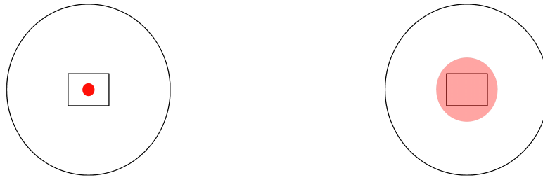
Abbildung 3.5 Skizzenhafte Darstellung der durch die Blenden gelangenden Anteile des Streulichts (rot) für identische Targets, bei guter (links) und schlechter (rechts) Fokussierung. Die Schlitzblende (rechteckig) des Q-Detektors und die Lochblende (kreisförmig) des S-Detektors sind (maßstabsgetreu) übereinanderliegend gezeichnet, um eine kompakte Darstellung zu ermöglichen.
