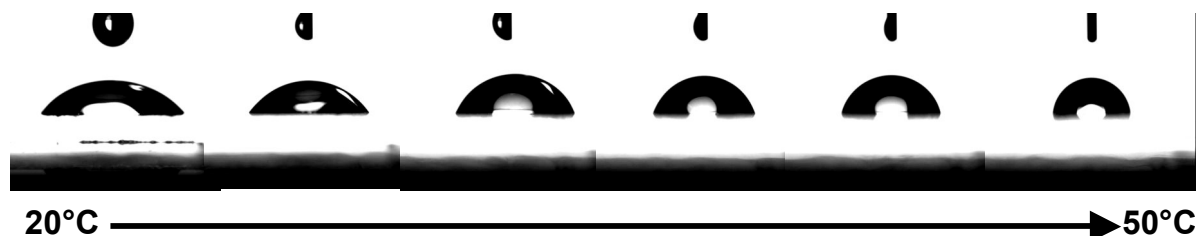
Abbildung 39: Kontaktwinkel an verschiedenen Stellen eines amphiphilen Blockcopolymerfilm aus Poly((4-Octylstyren)-block-(2-(2-(4-vinyl-phenoxy)-ethoxy)-ethanol) (BC 15), dessen Oberfläche zunächst komplett hydrophil orientiert und dann an Luft für 20 Minuten einem Temperaturgradienten von 20 °C bis 50 °C ausgesetzt wurde.
