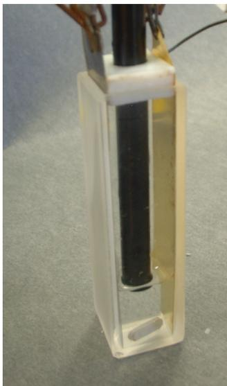
Abbildung 26: Elektrolysezelle in Form einer Glasküvette, hier mit einer Au-Arbeitselektrode.
