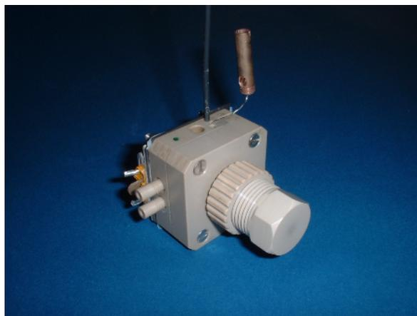
Abbildung 122: Elektrolysezelle für bandförmige Metallelektroden (Zelle Nr. 10).
