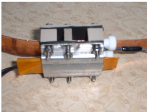
Abbildung 33: Elektrolysezelle mit zwei Kompartimenten und der Möglichkeit des Betriebs mit einer bandförmigen Elektrode (Zelle Nr. 9).
