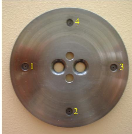
Abbildung 87: ALOHA-Sammelscheibe (aus Tantal) für die quasi-kontinuierliche Überführung von Aktivität aus einem Aerosol-Gasjet in die wässrige Phase. Pos. 1: Sammeln, Pos. 2: Lösen, Pos. 3: Spülen mit Aceton, Pos. 4: Trocknen mit Stickstoff.
