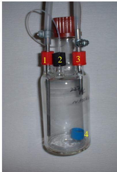
Abbildung 96: An Eisenhydroxid mitgefälltes  $^{227}\text{Ac}$  als  $^{219}\text{Rn}$ -Emanierquelle in einer Emanierkammer ( $V = 300\text{ ml}$ ) für KCl-He-Gasjetexperimente mit  $^{211}\text{Pb}$  und  $^{211}\text{Bi}$ . 1: He/KCl-Einlass, 2 Kapillare zur Chemieapparatur, 3 Manometeranschluss, 4 Emanierquelle.
