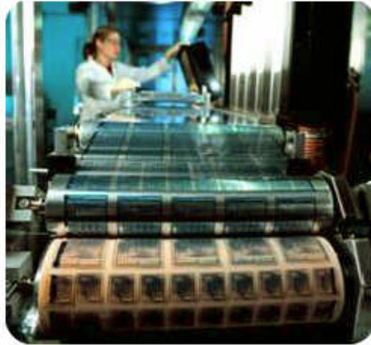
**Abbildung 2.100 Herstellung von RFID-Etiketten (Radio Frequency Identification) durch Drucken organischer Halbleiter.**
