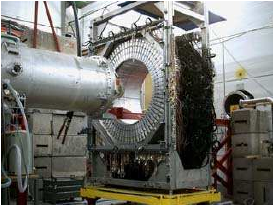
Abbildung 4.2: Foto des Bleifluoridkalorimeters, Blick in Strahlrichtung. Die Bleifluoridkristalle sind in 146 Rahmen montiert und umgeben die Streukammer - links im Bild - im kompletten Azimutwinkel. Die Polarwinkel bezüglich des Wasserstoff-Targets liegen zwischen 30^\circ und 40^\circ . Zum Zeitpunkt der Aufnahme war das Kalorimeter aufgrund anstehender Umbaumaßnahmen einige Meter strahlabwärts verschoben, was eine bessere Sicht auf die Konstruktion ermöglicht.
