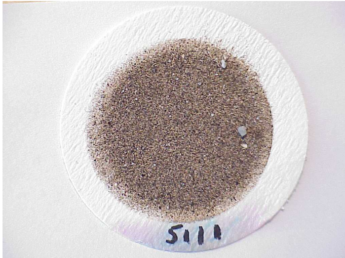
Abb. 6-33: Fotografische Aufnahme des Filtrerrückstandes der Wasserprobe aus dem unteren Filtermeter aus Brunnen 51a (WIACEK, 2004)
