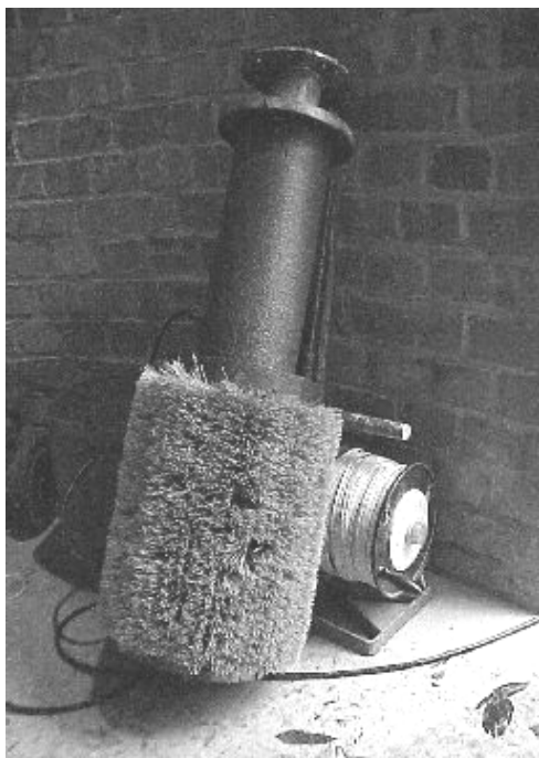
Foto 4-3: Mechanische Vorreinigung mit einer auf den Durchmesser angepassten Kunststoffbürste [WIACEK, 2004]
