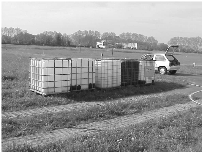
Foto 4-4: Container mit 1000 Liter Inhalt zum Auffangen des abgepumpten Wassers, 1000 Liter pro Filtermeter [WIACEK, 2004]
