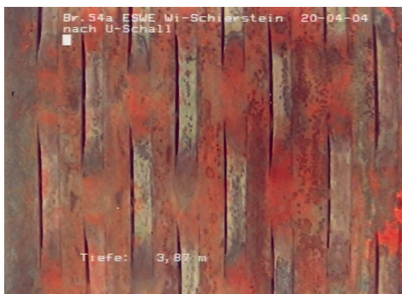
Abb. 6-20: Kamerabefahrung Brunnen 54a, 20.04.2004, Nach Ultraschallregenerierung, Bild 1 (links) aus 7,72 m u D-OK und Bild 2 (rechts) aus 10,46 m u D-OK [BRM, 2004]
