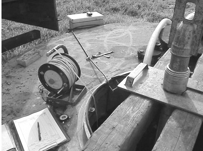
Foto 4-2: Durchführung eines der Pumpversuche an Brunnen 31a [WIACEK, 2004]
