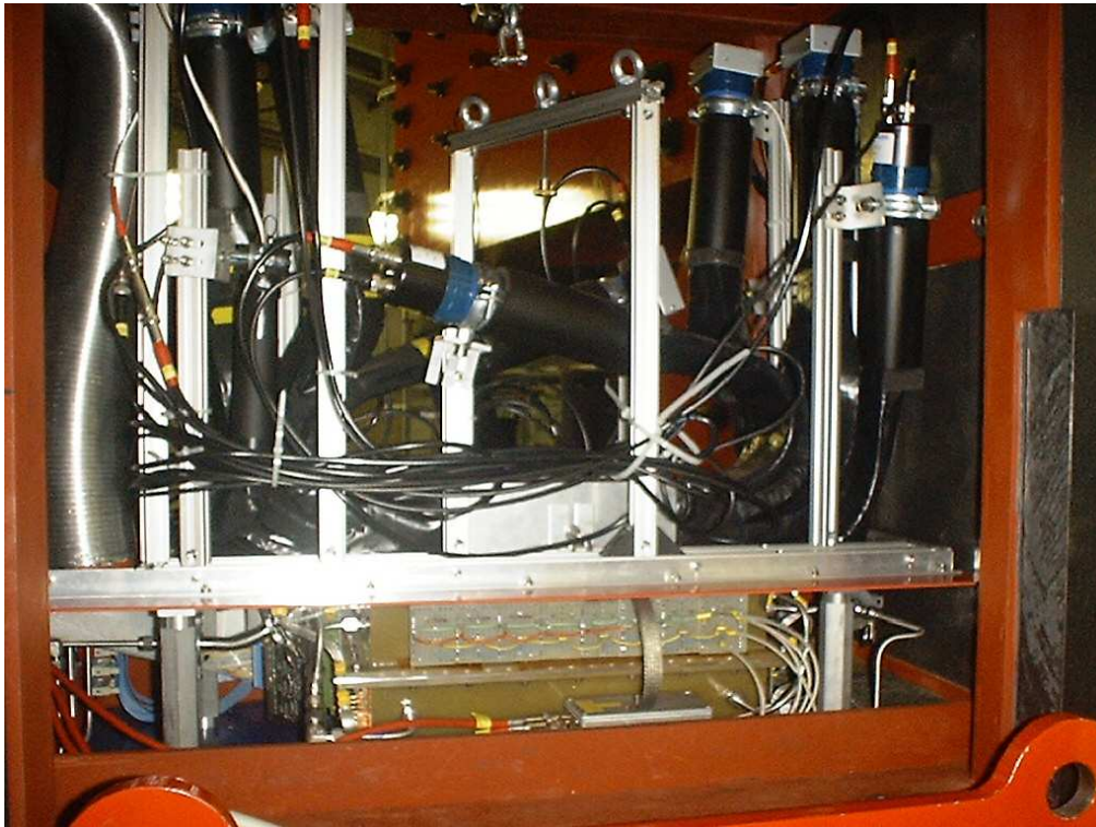
Abb. 3.8: Detektorsystem des Short-Orbit-Spektrometers, eingebaut im Abschirmhaus. Die rechte Seite ist die dem Target zugewandte Seite. Unten die Driftkammer, oben das Szintillatorsystem; zu sehen sind die Photomultiplier und die Lichtleiter, die Szintillatoren selbst befinden sich hinter der Aluminiumplatte in der Mitte. Ganz links ist der Entlüftungsschlauch zu erkennen, der die mit Helium angereicherte Luft aus dem Kammerbereich absaugt. Das Bild wurde von M. Weis aufgenommen.
