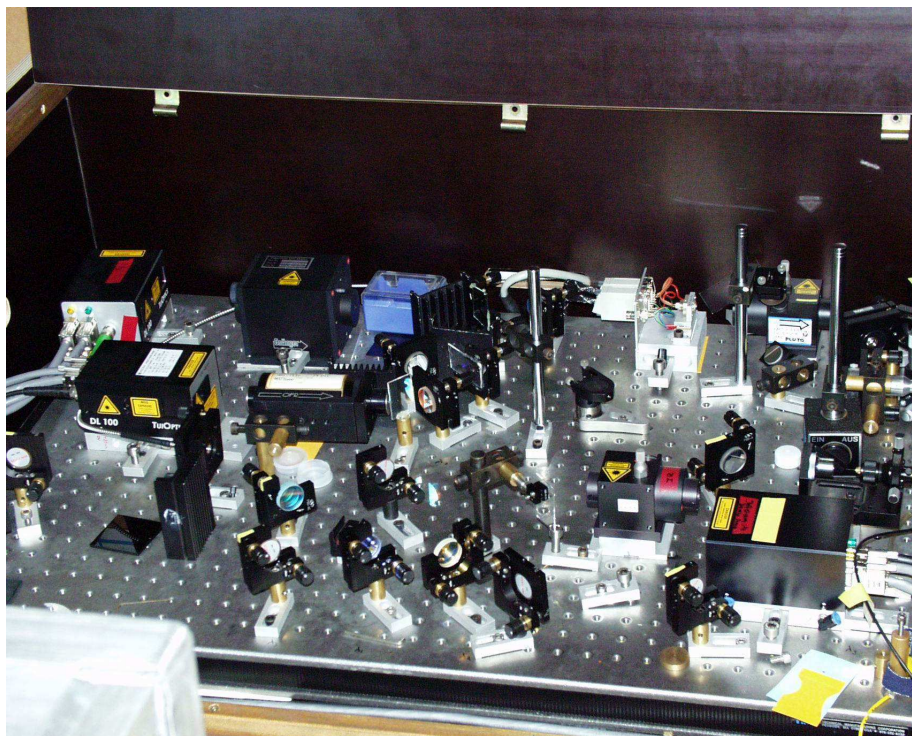
Abbildung D.2: Aufbau des Diodenlasersystems. Das Bild zeigt drei Diodenlaser (TOPTICA DL100), die mitsamt der Optik zur Strahlkontrolle und -zusammenführung auf einem 60 \times 90 cm großen Breadboard, das sich in einer transportablen Box befindet, montiert sind.
