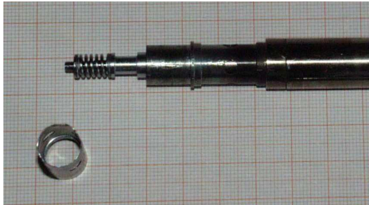
Abbildung D.1: Der auf einer Kwik-Connect Vakuumdurchführung montierte Tantal-Atomstrahlofen ist mit einem Wolfram-Heizfilament ( d=0,75 mm) verbunden. Unten links sieht man das aufsetzbare Molybdän-Hitzeschild.
