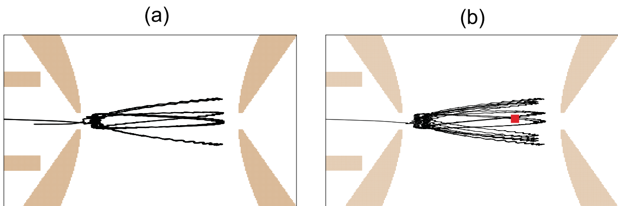
Abbildung 4.7: Beispiel für die Relevanz von Puffergasmolekülen zum Einfangen der Ionen. In (a) findet kein Stoß innerhalb der Falle statt. Das eingeflogene Ion verlässt die Falle wieder. In (b) ist ein Stoß mit einem roten Quadrat markiert. Durch die Kollision verliert das Ion Energie und wird endgültig eingefangen. Die Parameter sind in beiden Simulationen identisch. Die zurückgelegte Wegstrecke des Ions im Inneren der Falle beträgt in (a) etwa 20 cm. Die mittlere freie Weglänge liegt hingegen bei 94 cm.
