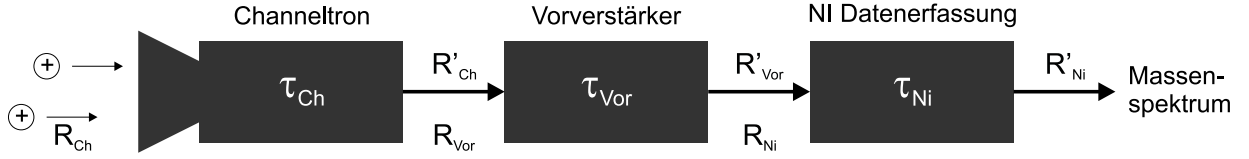
Abbildung B.1: Veranschaulichung der vorzunehmenden Totzeitkorrekturen. Mit R bezeichnete Zählraten stellen die wahren Zählraten dar, mit R' bezeichnete die gemessenen Zählraten. Die Totzeiten sind mit den Parametern \tau angegeben.
