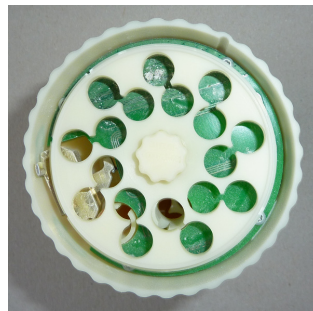
Abbildung 4.1.-4: Entnahmemechanik und -elektronik. Nach Befüllung wird der drehbare Ring auf den Dispenser geschraubt
