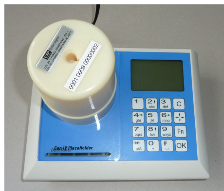
Abbildung 4.1.-6: OtCM™ e-Dispenser auf dem DataTaker™
