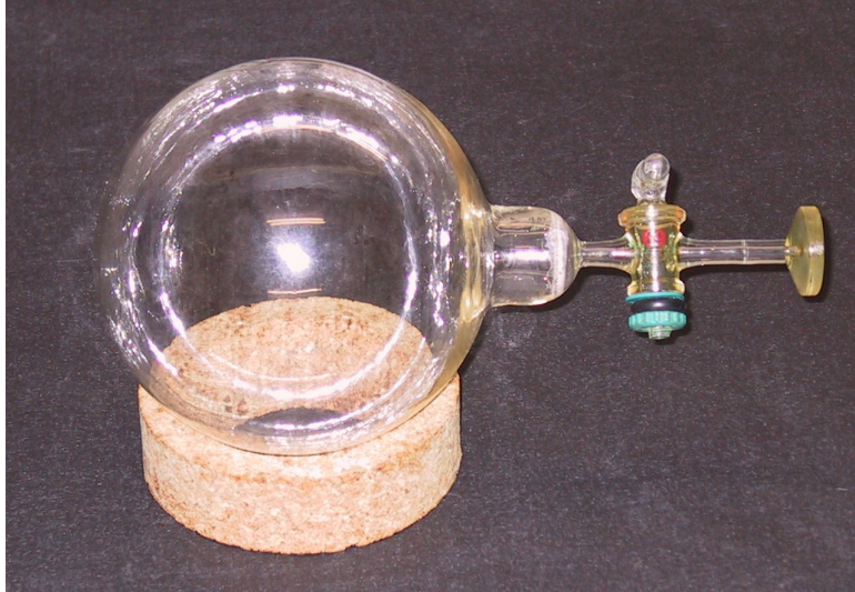
Abbildung 2.4: Sphärische Transportzelle aus Aluminomsilikatglas GE180
