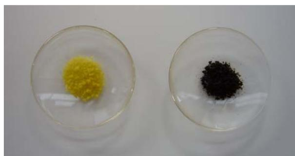
**Abb. 3.13.9:** Das mit dem photolabilen Linker beladene AMPS-Harz vor (links) und nach der UV-Bestrahlung (rechts).
