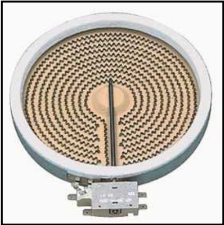
Abb. 5.9: Infrarotheizstrahler für die Erwärmung der Flüssigkeit im Versuchsbecken.
