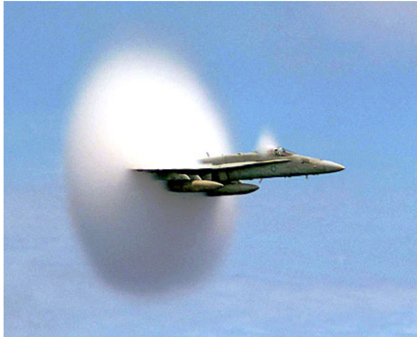
Abbildung 4.9: Entstehung einer kegelförmigen Wolke am Heck und der Pilotenkanzel eines Düsenjet-Flugzeug durch Expansion und damit adiabatischer Abkühlung der Luft beim Überschreiten der Schallgeschwindigkeit [Universität München, (2008)].
