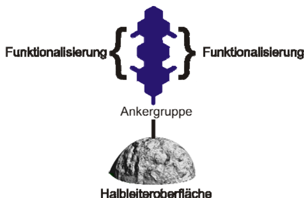
Abbildung 21: Schematische Darstellung eines an eine Halbleiteroberfläche gebundenen Terrylendiimids.
