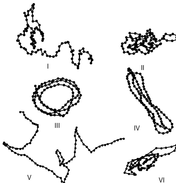
Abbildung 2.17: Typische Konformationen einer Polymerkette auf Grundlage von Monte-Carlo-Simulationen: (I) random coil (II) molten globule (III) Toroid (IV) Stab ( rod ) (V) Defektknäuel und (VI) Defektzylinder (aus [47])
