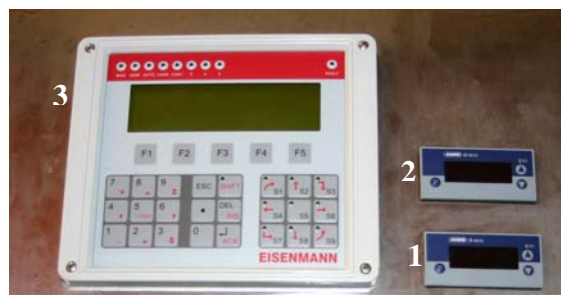
Abbildung 9: Temperaturanzeige des Ein- und Auslaufs (1 und 2) und das Bedienelement der Elektroimpulsanlage (3, Steuerung der Membranpumpe und des Drucks in der Funkenstrecke).
