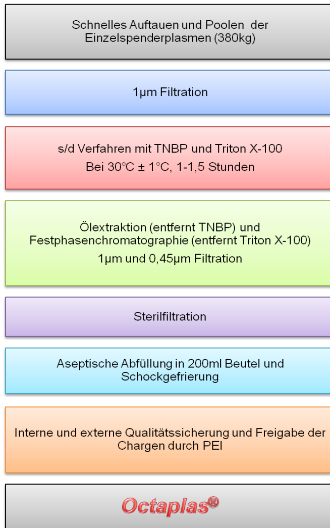
Abb. 8: Herstellung von solvent / detergent behandeltem Plasma (Octaplas®) [7].
