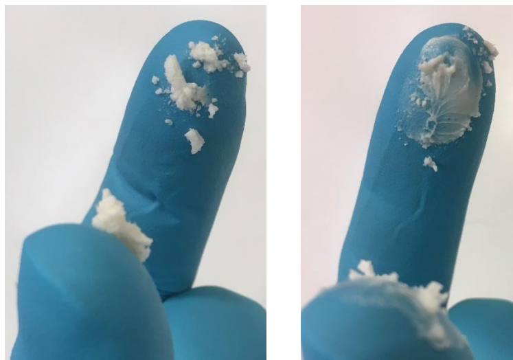
Abbildung 10 Verflüssigung der plastischen Zubereitung durch leichten Scherstress
