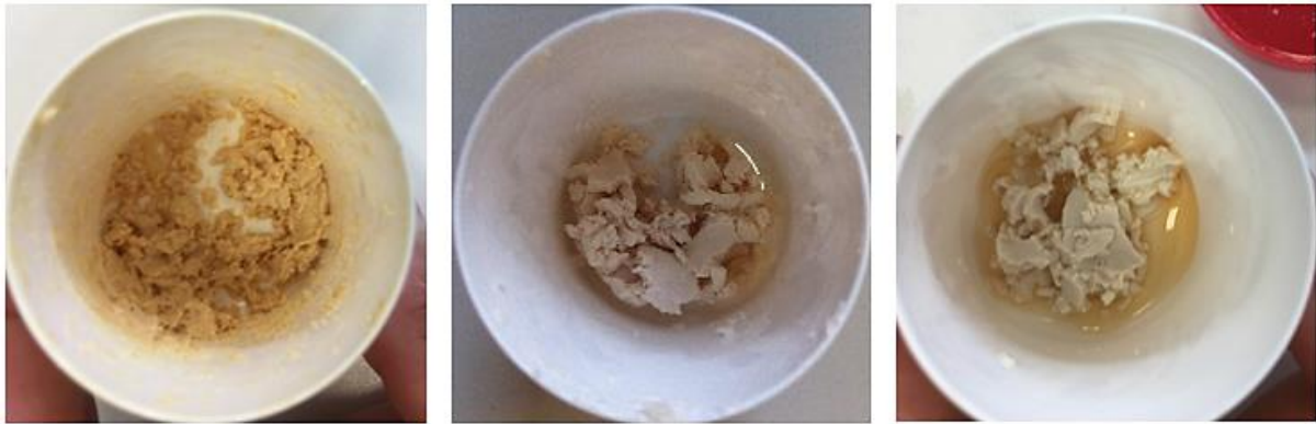
Abbildung 55 Zeitlicher Verlauf der Phasentrennung in ImiSOL binnen ca. 4 Wochen Das Ausbluten trat nur bei vereinzelt Chargen auf, verstärkte sich dann aber über die Lagerung. Die Bilder wurden in nicht definierten Zeitabständen innerhalb ca. 4 Wochen aufgenommen.
