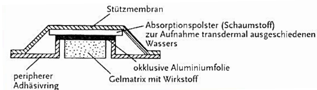
Abbildung 56 Schematische Darstellung eines TTS Typ Matrixsystem nach Voigt
