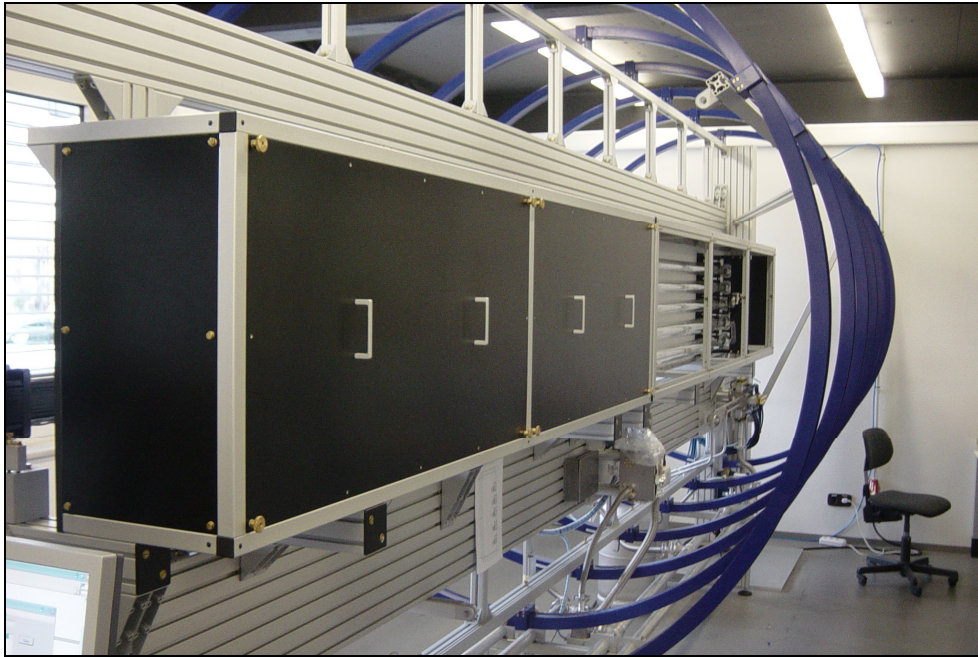
Abbildung A.1: Seitenansicht „Helios“. Zu erkennen sind die 2m Spulen (blau) und die OPV im hinteren Bereich und im Vordergrund die von der Abdeckung geschützte Optik. Die Apparatur wird von einer Mittelwand aus verwindungssteifem Aluminiumwabenmaterial getragen.
