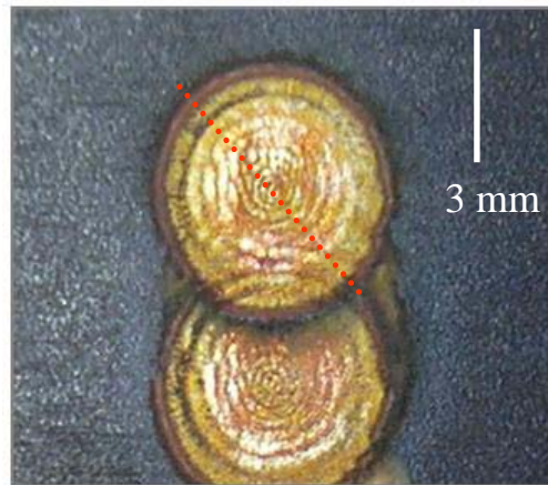
Abb. 9.11.: Fotografische Aufnahme der beobachteten konzentrischen Struktur nach UV-Laserablation einer gebeizten Messingoberfläche. Die Strichlinie wurde zur Extraktion eines Helligkeitsprofils gelegt.
