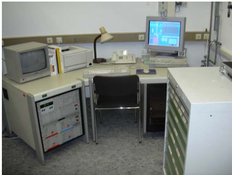
C.2.: Arbeitsplatz zur Datenaufnahme und zur Steuerung des MALDI-TOF-Massenspektrometers (Bruker Reflex III).
