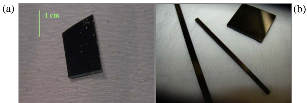
Abb. 2.3.: Siliciumkarbid-Target mit der im Text beschriebenen Gadolinium-Implantation. Der Implantationsbereich erscheint schwarz, während eine schmale nicht-implantierte Zone grünlich vor dem Hintergrund schimmert. (b) Verschiedene Formen von implantierten Glaskohlenstoff-Targets, welche zur methodischen Spezifikation eingesetzt wurden.
