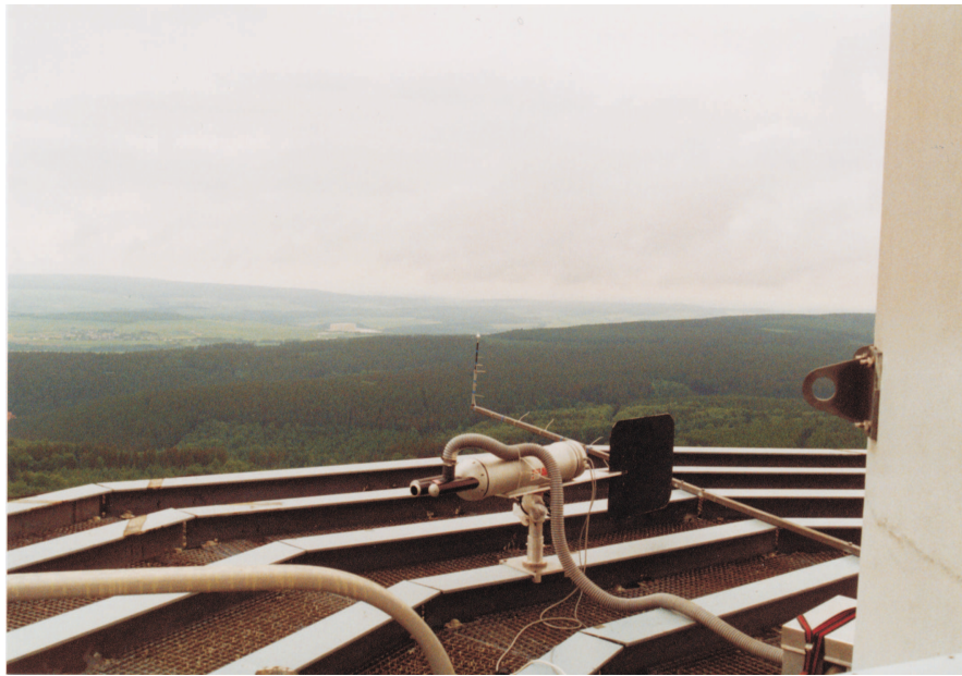
Abbildung A.5: Aufbau des Kollektors in der Turmmitte, dessen Meßdaten mit F_M bezeichnet waren. Zudem zu sehen ist die Forward Scattering Spectrometer Probe (FSSP) zur Messung der Tröpfchengrößenverteilung der Wolken.
