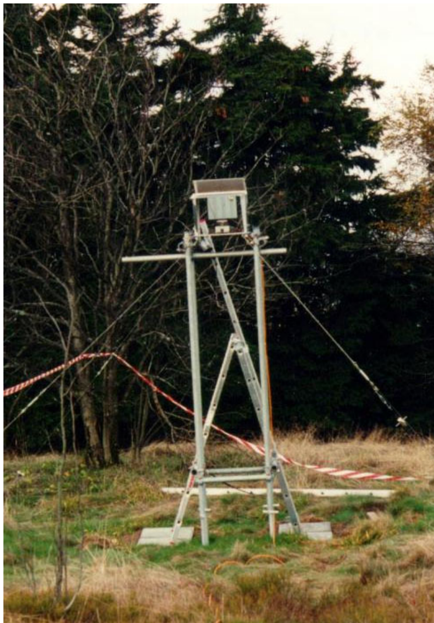
Abbildung 4.5: Der Umlenkspiegel ist in einem Aluminiumkasten mit aufstellbaren Deckeln auf einem Gestell mit Schraubfüßen angebracht. So läßt er sich leicht an den Aufstellort anpassen und in der Höhe einjustieren.
