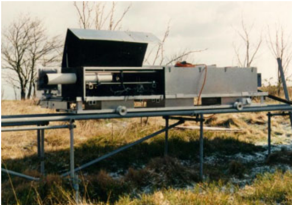
Abbildung 4.3: Der herausfahrbare Wagen mit dem Schutzgehäuse für den Laserkopf (rechts) und dem Gehäuse für die Aufweitungsoptik (links). Darin ist die 4-Stangenbank und der (weiße) Tubus zu sehen. Ganz links ist die Kamera für das kleine Volumen an den Wagen herangeklappt (hinter dem Tubus, unter der Plastikfolie).
