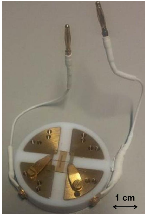
Abb. 5.4: Beschichtete und im Probenhalter kontaktierte IDE.
