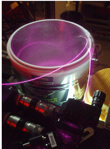
Abbildung 2.26: Dotierte Faser in flüssigem Stickstoff. Die Faser liegt direkt in flüssigem Stickstoff, sodass es einen optimalen Wärmeübertrag gibt. Die Aufnahme wurde während des Betriebs mit einer Kamera ohne Infrarot-Filter gemacht, das infrarote Licht erscheint pink.
