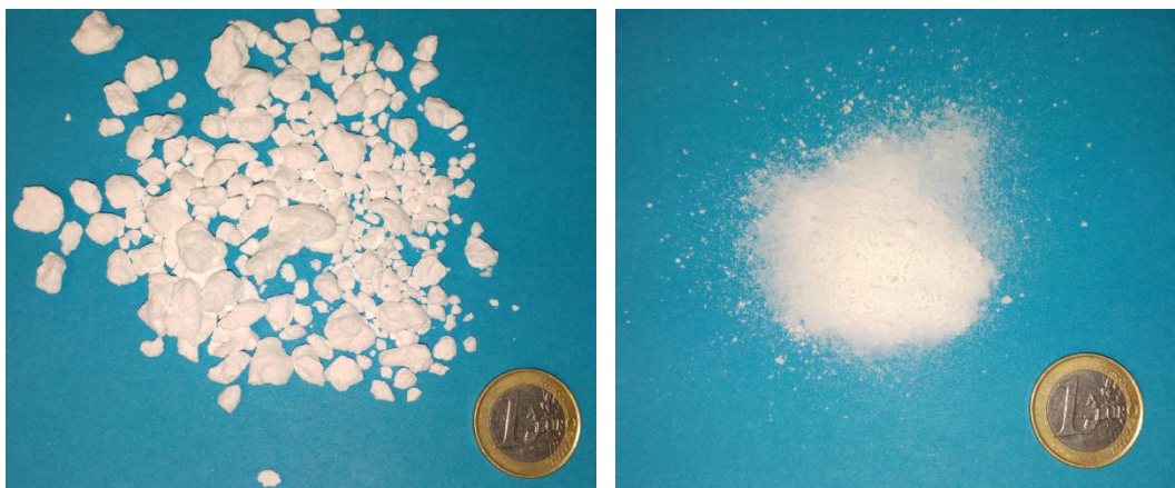
Abbildung 1-10: Metallocenkatalysiert hergestellte PE-Partikel. Homogen, ohne Träger (links) und heterogen polymerisiert mit einheitlicher Größenverteilung und höherer Schüttdichte (rechts).
