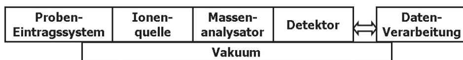
Abbildung 4.1.: Schematischer Aufbau von Massenspektrometern. Für jede Baugruppe gibt es unterschiedliche Realisierungsmöglichkeiten, die je nach analytischer Aufgabenstellung ausgewählt werden.
