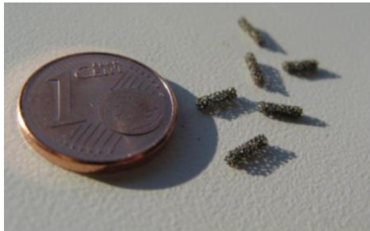
Abbildung 2.34: Recemat Nickelschaum – ca. 4% Raumfüllung [143]
