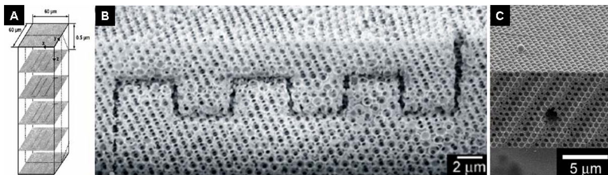
Abbildung 44: A) Aufnahmen eines konfokalen Mikroskops die einen im Opal eingebetteten Defekt zeigen; 146 B) SEM-Bild einer Opal-Bruchkante mit 3D Defekt im Inneren des Opals; 147 C) SEM-Bild eines 3D Luftdefektes in einem inversen Silizium-Opal. 149
