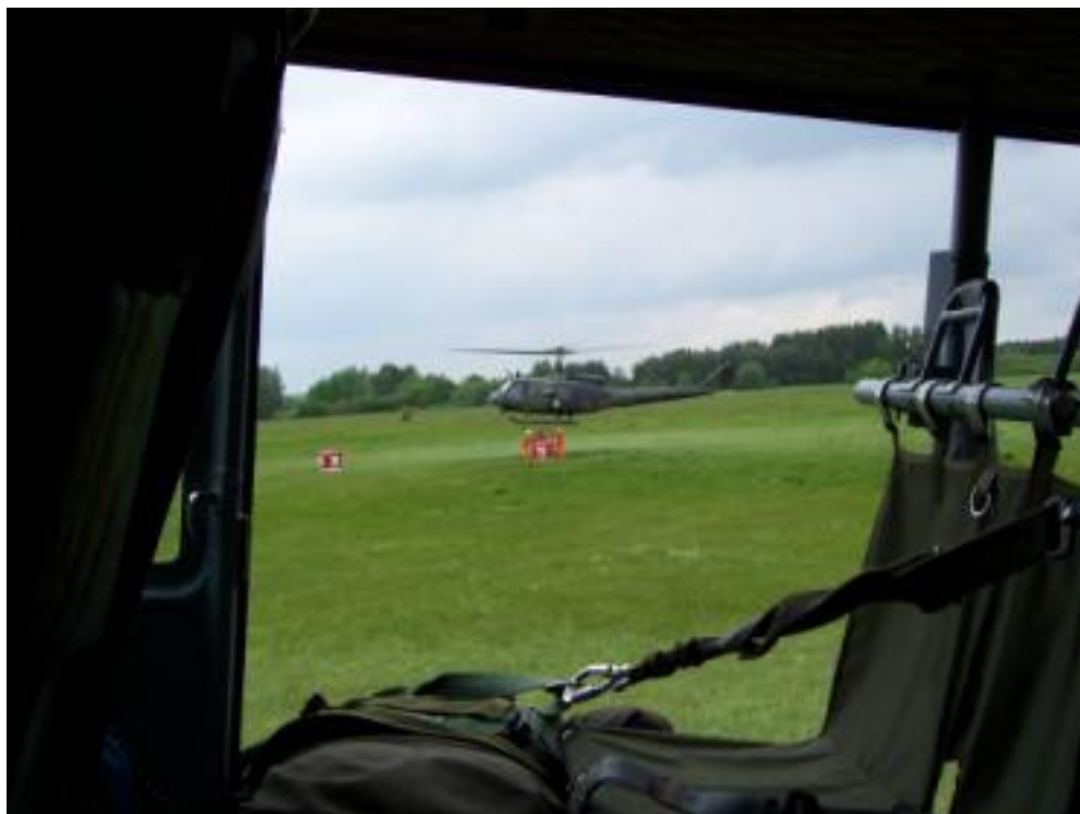
Abb. 113: Blick aus einer Bell UH 1 D auf eine Maschine gleichen Typs. Ein Mitglied der Bordmannschaft liegt auf dem Boden und beobachtet die Tätigkeiten der Bodenmannschaft unter der Maschine. Während die „Bells“ hovern können die Außenlastbehälter mit Schläuchen befüllt werden.
