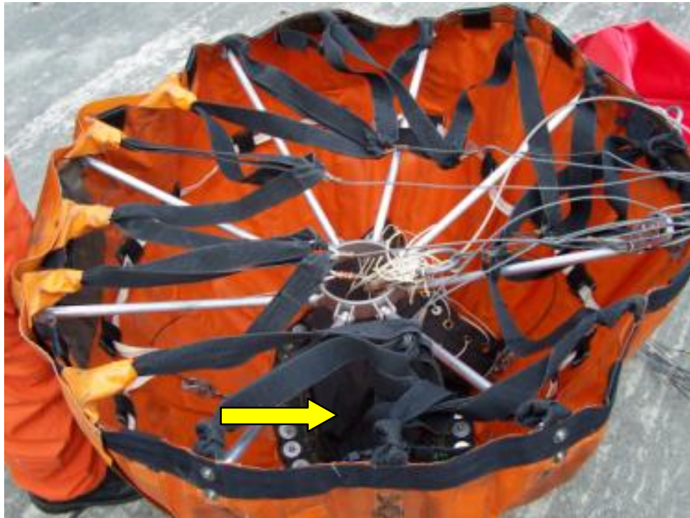
Abb. 105: Blick in den Bambi Bucket der Polizeihubschrauberstaffel in Roth. Der untere Teil des Behälters (schwarz) ist nach innen gestülpt (siehe Pfeil). Über einen Flaschenzug wird dieser Entleerungsschlauch freigegeben und das Wasser fließt schlagartig aus. Ein intermittierendes Löschen ist somit nicht möglich.
