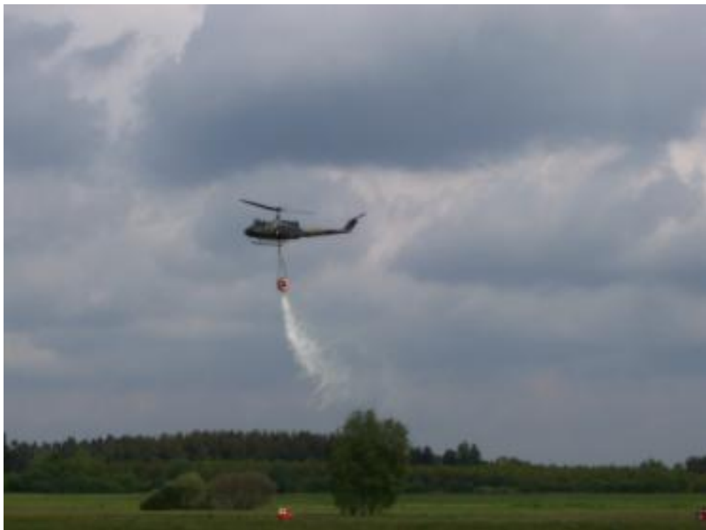
Abb. 104: Sprühabwurf mit dem SMOKEY III (teilgefüllt). Die Bell UH 1 D ist im Vorwärtsflug. Der Wasserteppich wird über der Brandstelle (hier die Buschgruppe) ausgezogen.
