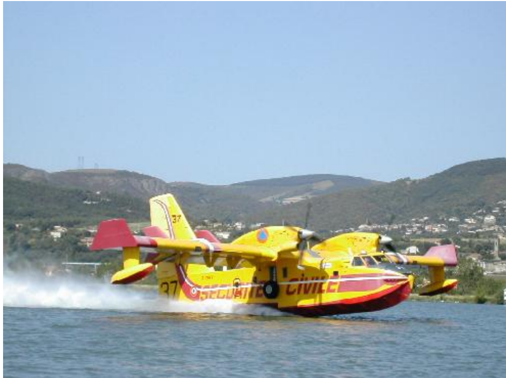
Abb. 96: Löschflugzeug vom Typ CANADAIR bei der typischen touch and go Betankung. Solche Flugzeuge kamen auch bei der Waldbrandkatastrophe in Niedersachsen 1975 zum Einsatz (WWW.ESIL.UNIV-MRS.FR).
