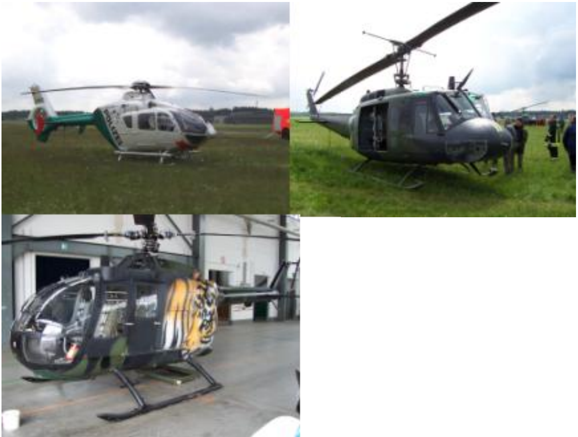
Abb. 128-130: Drei der wichtigsten Hubschrauber für den Außenlastbehälterereinsatz. Die EC 135 (links oben; hier eine Polizeimaschine), die Bell UH 1D der Bundeswehr (rechts oben) und die BO 105 ebenfalls eine Bundeswehrmaschine (links unten). Die Maschinen vom Typ BO 105 der Bundeswehr sind zur Zeit (!) allerdings nicht für den Außenlasttransport geeignet.
