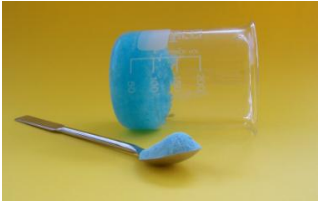
Abb. 122: Gelbildner wie das pulverförmige Hydrex ® dicken das Wasser ein und verhindern so ein Abfließen vom Brandgut. Die auf dem Löffel liegende Menge Hydrex ® (2g) reicht aus, um 100 ml Wasser derart einzudicken, dass ein Fließen aus dem Becherglas vollständig unterbunden wird. (Für den Brandeinsatz wird auf diese Menge Wasser nur 1g zugemischt.)
