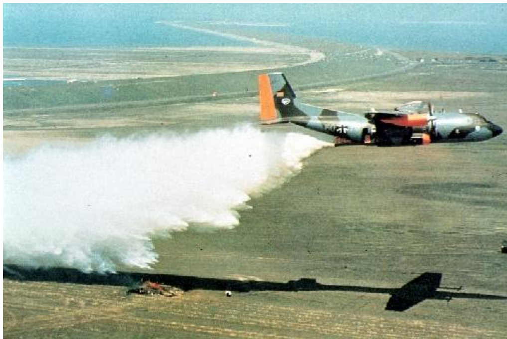
Abb. 98: Transportflugzeug TRANSALL C-160 mit dem für diese Maschine entwickelten Umrüstsatz für die Brandbekämpfung aus der Luft. Hier bei einem Übungsabwurf mit Wasser, ohne Retardant (BILDARCHIV LFS CELLE).
