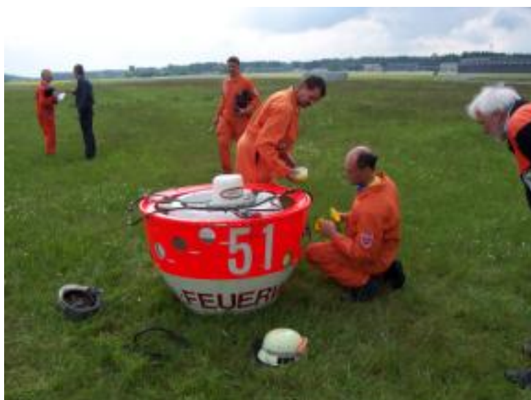
Abb. 114: Die Bodenmannschaft bereitet den Außenlastbehälter Chadwick C 140 für den Einsatz vor. Durch Entfernen der Verschlussstopfen in der Außenwand wird hier die Füllmenge von möglichen 530 l auf 265 l verringert.
