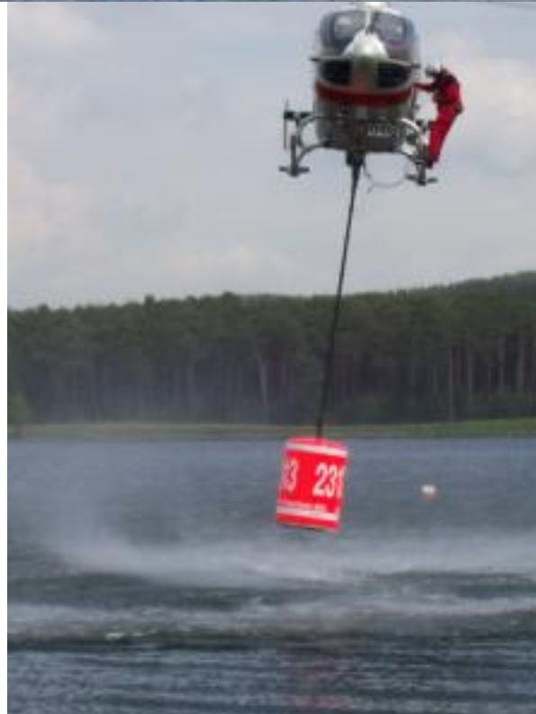
Abb. 110 bis 112: Das Befüllen der Außenlastbehälter im Flug. Die Maschine senkt den Behälter auf die Wasseroberfläche des Großen Rothsees ab. Dieser schwimmt zunächst auf und versinkt dann. Sobald der Behälter vollständig gefüllt ist, wird dieser wieder aus dem Wasser gezogen. Deutlich sind die starken Rotorabwinde ( downwash ) auf der Wasseroberfläche erkennbar.
