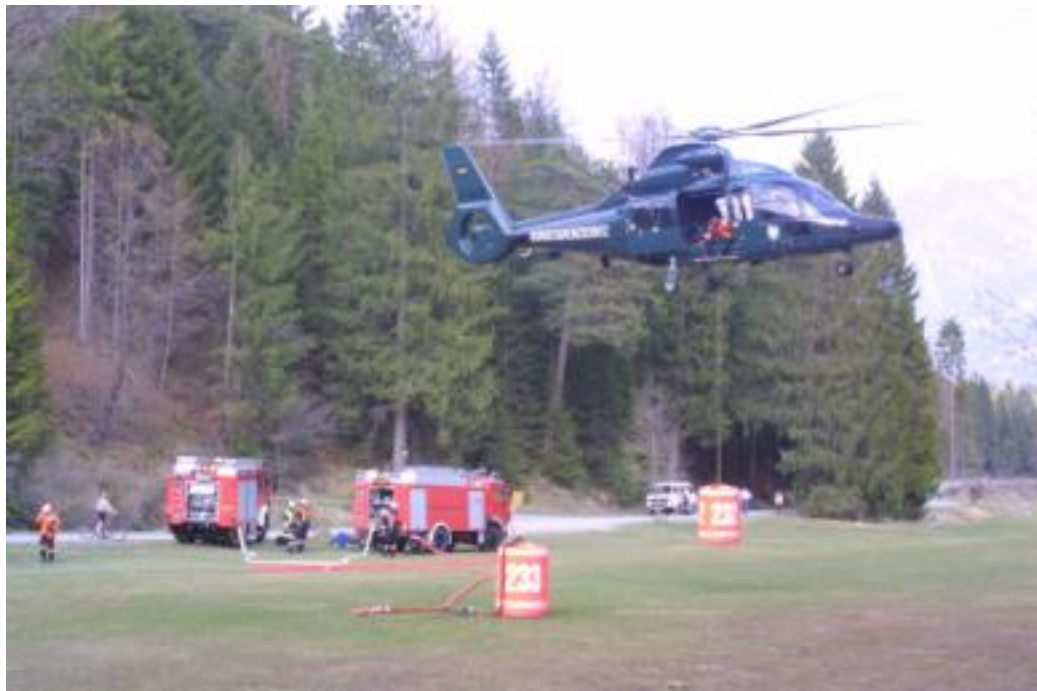
Abb. 135: Einsatz der EC 155 der Bundespolizei (hier noch Bundesgrenzschutz) mit Behältern vom Typ Semat FPG beim Brand im Bereich der Kammerlainböden in der Nähe von Garmisch-Partenkirchen am 20. April 2003 (WWW.FFGAP.DE).
