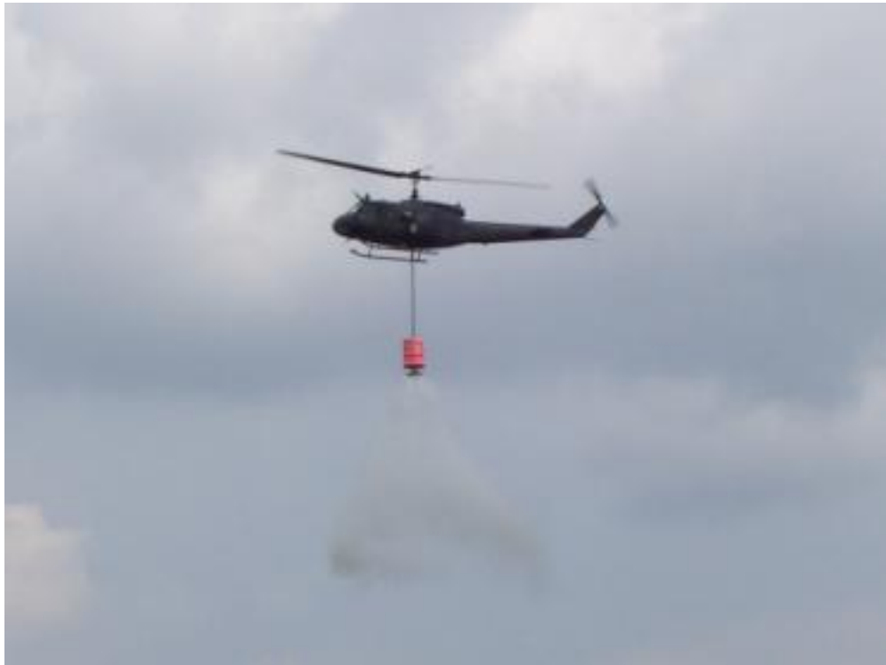
Abb. 103: Vollabwurf mit dem SEMAT FPG (900 l). Die Bell UH 1 D hovers über der Brandstelle. Deutlich ist die Wasserglocke zu erkennen, die durch das Absenken der Bodenplatte und das Abfließen des Wassers über einen schmalen Spalt entsteht.
