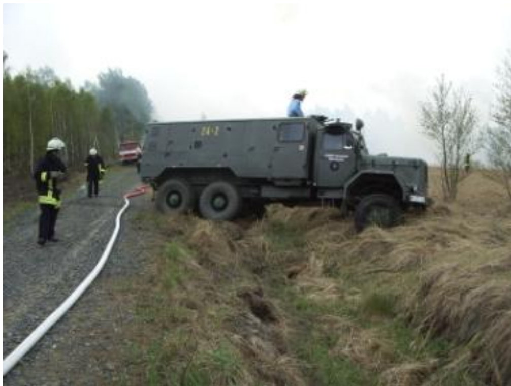
Abb. 42: Geländegängige Fahrzeuge, wie dieses Tanklöschfahrzeug der Bundeswehr, sollten ihren Geländevorteil nutzen und sich dem Feuer nähern (optimal allerdings aus dem Schwarzen ). In Engstellen sollten Fahrzeuge dabei rückwärts einfahren, damit eine schnelle Flucht möglich ist (FF WEIßWASSER).
