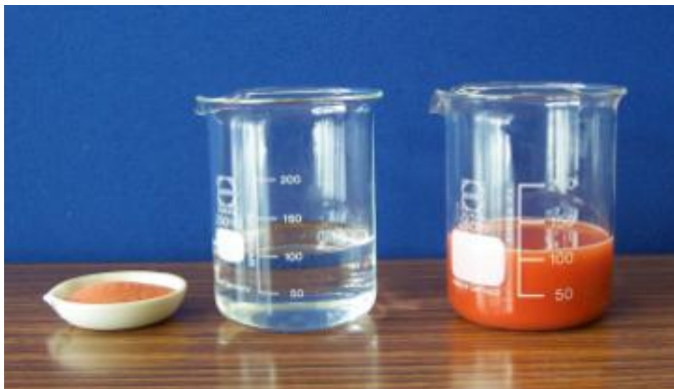
Abb. 121: PhosCheck® als Pulver und in angemischter Form. 14g des pulverförmigen Retardants PhosCheck® werden mit 100 ml Wasser vermischt. Das Ergebnis ist eine Flüssigkeit, die nach einiger Zeit leicht aufquillt und somit an Zweigen besser haftet.
