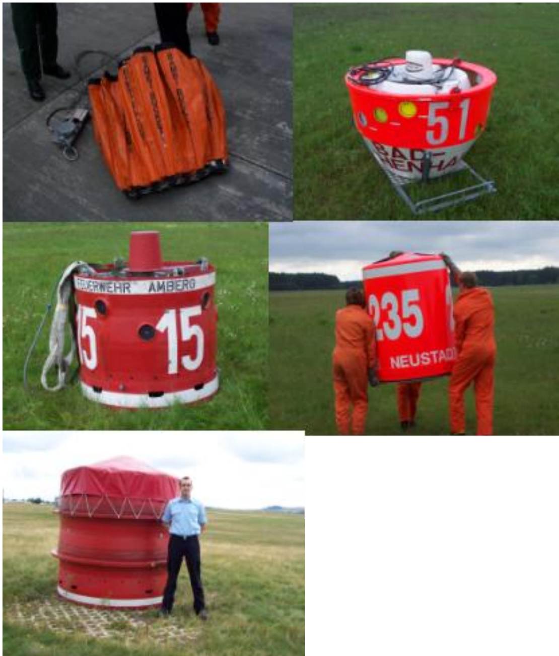
Abb. 123-127: Einige der in Deutschland verbreiteten Außenlastbehältertypen. Der Bambi Bucket mit 454 Litern Inhalt (links oben), der Chadwick C 140 mit maximal 530 Litern Inhalt (rechts oben), der SMOKEY III mit maximal 900 Litern Inhalt (Mitte links), der SEMAT FPG mit maximal 900 Litern Inhalt (Mitte rechts ) und der SMOKEY I mit maximal 5000 l (unten links).
