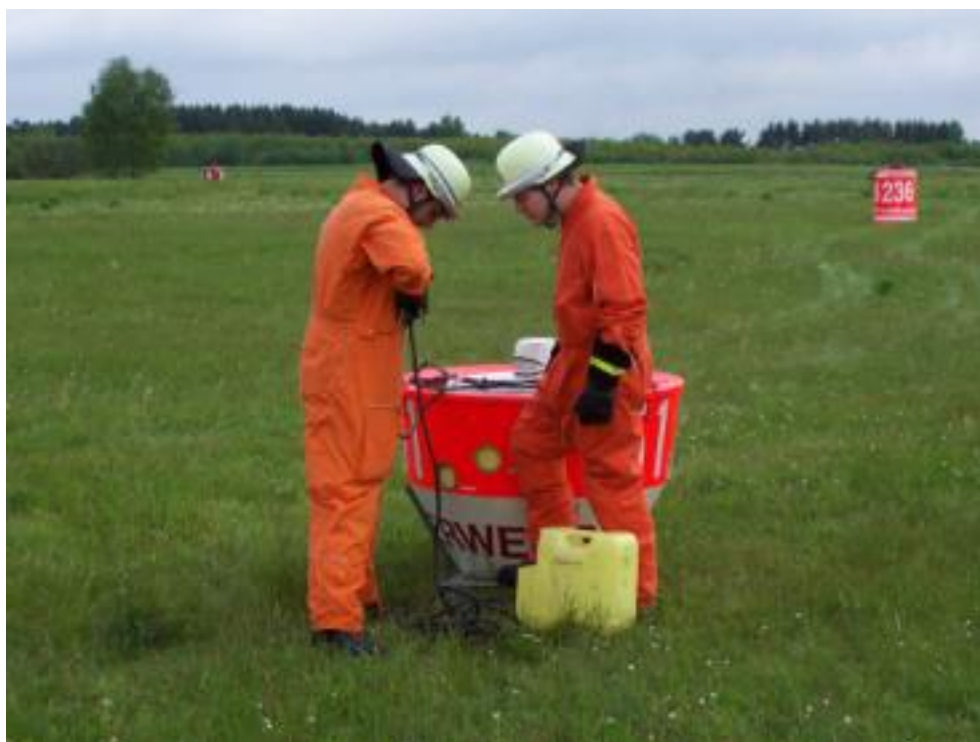
Abb. 117: Vorbereitung des Landplatzes durch die Bodenmannschaft. Die Behälter werden mit ausreichendem Abstand auf dem Platz verteilt (hier: SMOKEY III, Chadwick C 140 und SEMAT FPG) und für den Einsatz vorbereitet: Lastgeschirre werden befestigt, Füllmengenbegrenzer geöffnet und Auslöseeinrichtungen vorbereitet.
