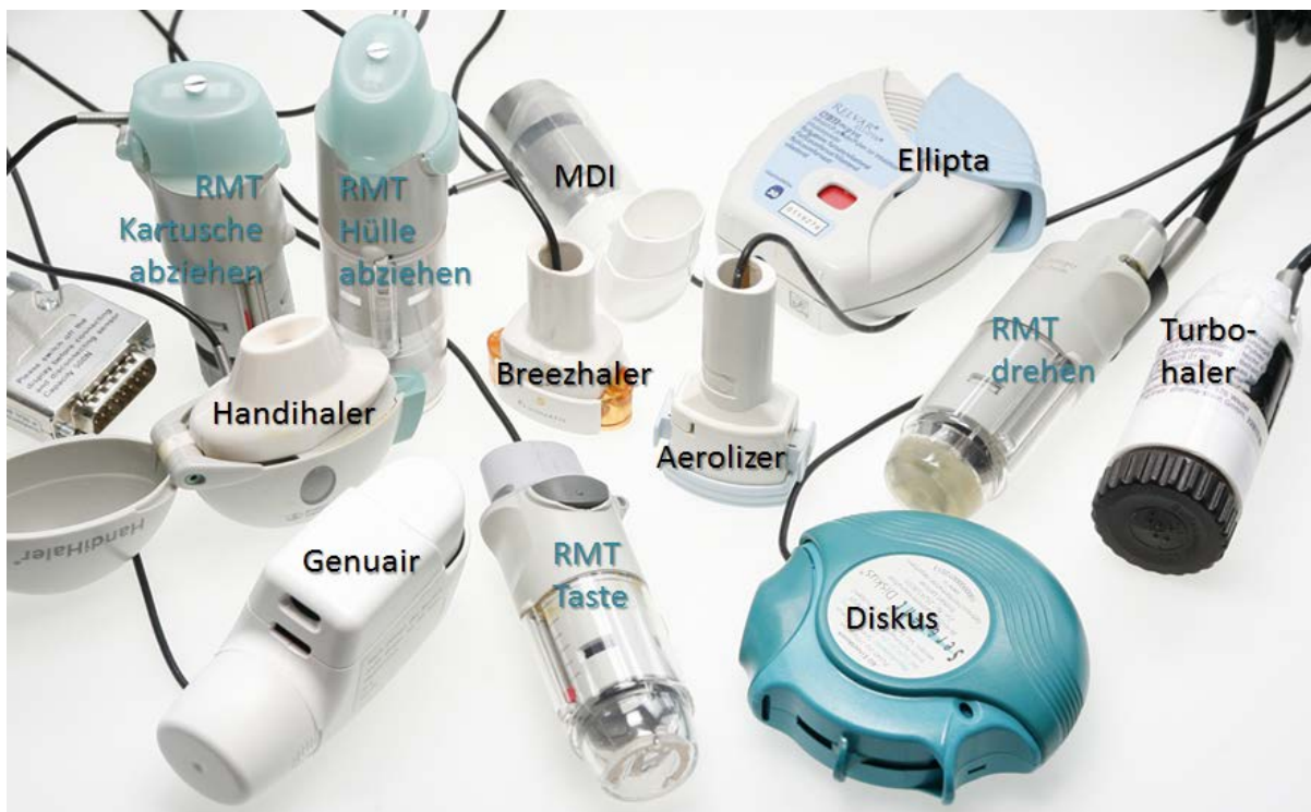
Abbildung 25: Fotos von der Inhalatoren mit eingebauten Drucksensoren
