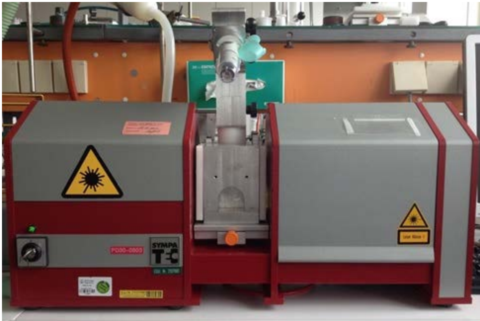
Abbildung 17: Sympatec Laserbeugungsgerät zur Partikelgrößenbestimmung, mit Rachenmodell und Adapter für RespiMat
