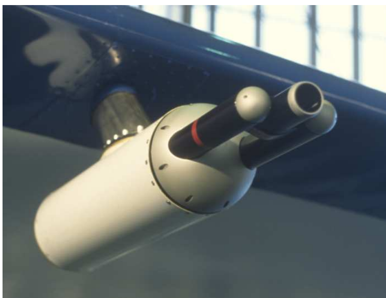
Abbildung 2.2: Das flugfertig montierte FSSP-300 an der Fläche der Geophysika.
