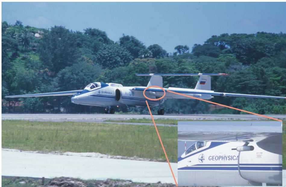
Abbildung 3.2: Das russische Höhenforschungsflugzeug Geophysika. Das FSSP-300 ist an der linken Fläche montiert (aus THOMAS et al. [2002], ©2002 American Geophysical Union).
