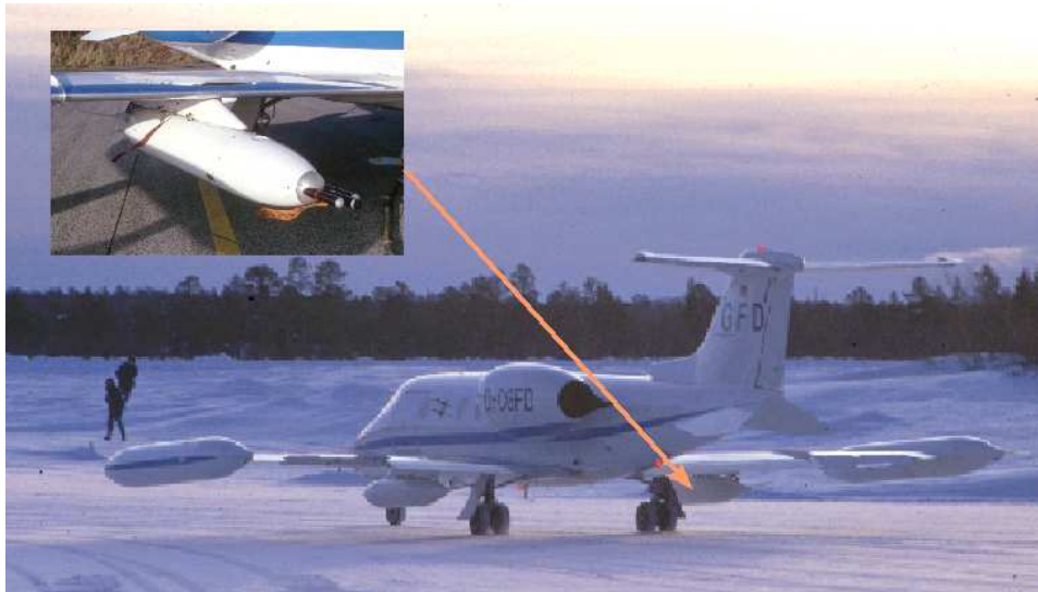
Abbildung 3.6: Der GFD Learjet, Außenlasttank der enviscope GmbH mit montiertem FSSP-300.
