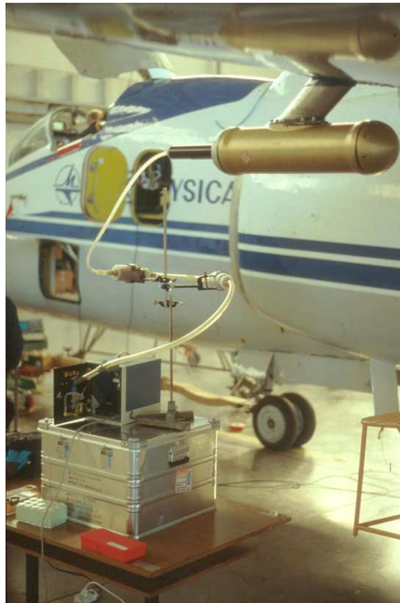
Abbildung 2.3: Testaufbau zur Kalibrierung des FSSP-300 während einer Meßkampagne in Pratica di Mare (Italien). Das FSSP-300 ist an der Geophysika montiert. Siehe auch Schemazeichnung in Abbildung 2.4 .
