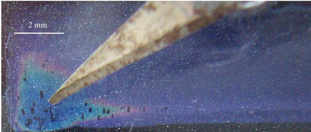
Abbildung 2.69.: Punktförmiger Druck auf eine PDMS-Replika in Aceton
