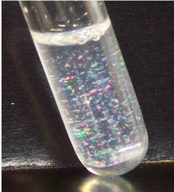
Abbildung 2.102.: In Eb600 dispergierte Kristallflocken der Probe P15-07<sup>[78]</sup>
