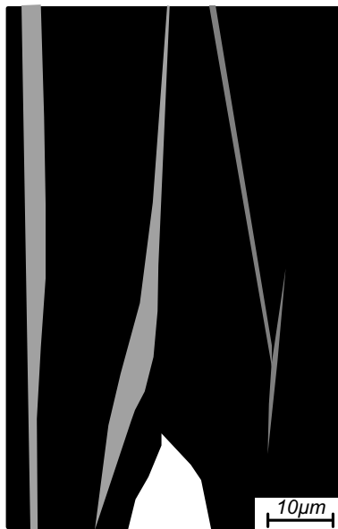
Abbildung 6.19: Nachzeichnung von Abbildung 7.8 a) aus [MICH92]. Es handelt sich um eine TEM-Aufnahme von homogenen Crazes (grau) um die Reißspitze (weiß) in einer Volumenprobe von PMMA. Sie sind entlang des Risses (von unten ins Bild kommend) orientiert. Zitat "Die in Abbildung 7.8 erkennbaren Crazes zeigen entweder keine oder eine nur schwach ausgeprägte Fibrillierung".
