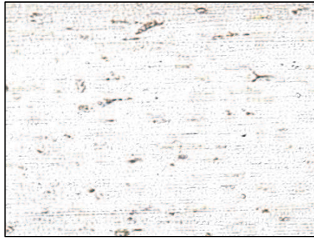
Abbildung 4.8: Oberfläche einer gewalzten Aluplatte wie sie zum Pressen der Polymersandwichs verwendet wurde. Die Größe des Bildausschnittes entspricht dem in Abbildung 4.4.
