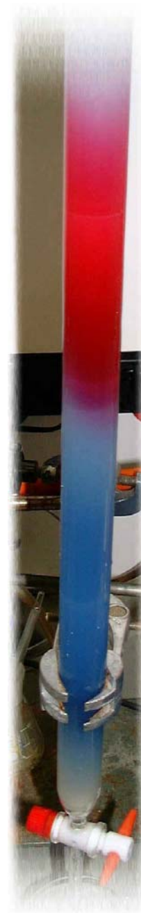
Abbildung 5-34: chromatographische Trennung von 60 (rot) und 65 (blau)
