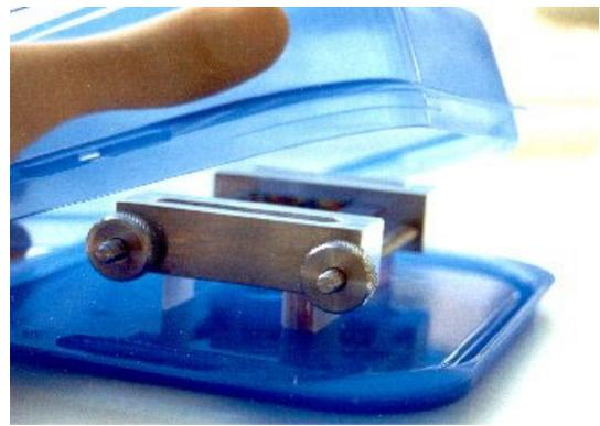
**Abbildung 3-13, Luftdichte Inkubationskammer**
