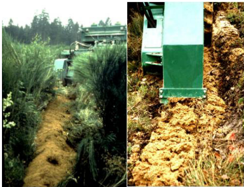
Abb. 6.7: Bearbeitung von trockenen Böden mit Lockerungseffekten (links) und von nassen Böden mit Zerstörung des Porengefüges (rechts), aus SCHÜLLER et al. (2002)
