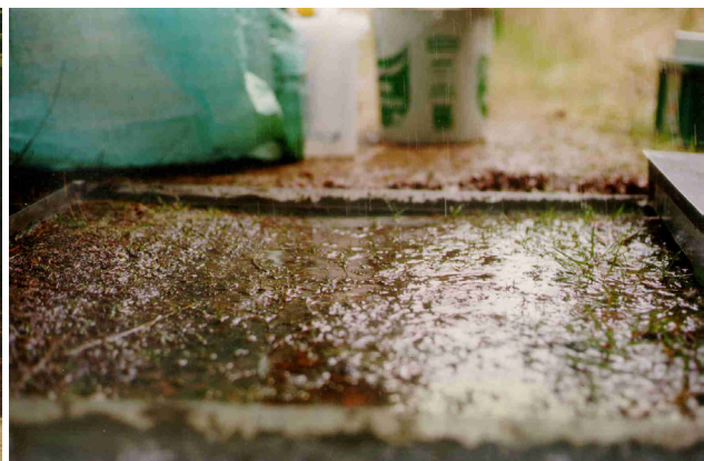
Abb. 4.4: Beregnete Fläche des Kleinregners während einer Beregnung (Foto, GIEK)
