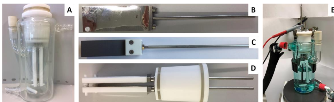
Abbildung 12: Equipment für präparative Elektrolysen in einer ungeteilten Zelle – A) Seitenansicht der doppelwandigen Glaszelle. B) Draufsicht auf eine Pt-Elektrode. C) Draufsicht auf eine BDD-Elektrode. D) Seitenansicht des Teflonstopfens mit zwei Pt-Elektroden. E) Seitenansicht des Elektrolyseaufbaus mit BDD-Anode und Pt-Kathode.
