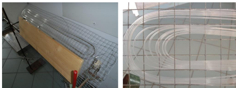
Abbildung 10.10: Für flusschemische Belichtungen mit natürlichem Sonnenlicht verwendeter Mikroreaktor („Sunflow“-Reaktor) von [REDACTED]. Links: Übersicht über den Reaktor; Rechts: Nahaufnahme des in einen Hasendraht geflochtenen FEP-Schlauchs. Der Reaktor ist nicht in Betrieb.
