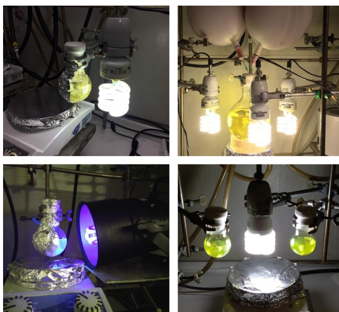
Abbildung 10.8: Beispielhafte Belichtungen präparativer Photoredoxreaktionen mit einer 25 W UV/Vis-CFL (oben links und rechts, letzteres als Multigramm-Ansatz) sowie mit einer 25 W UV-A-Energiesparlampe (unten links) und einer 23 W Vis-CFL Haushaltslampe (unten rechts).
