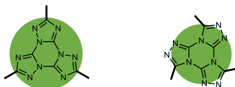
Abbildung 11: Radiales TTT (links) und tangenciales TTT (rechts) mit angedeuteter Orientierung der Substituenten
