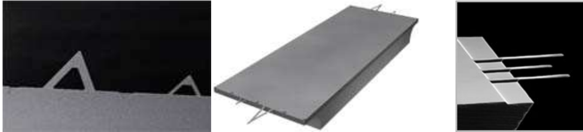
Abbildung 28 Beispiel verwendeter Cantilever (Quelle: www.nanoworld.com , www.spmtips.com )
