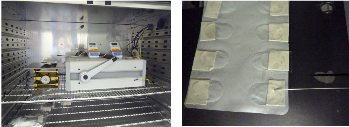
Abbildung 36 links das MicroGC – Gerät in einem Klimaschrank, rechts ein Blister mit der Probennadel im Napf
