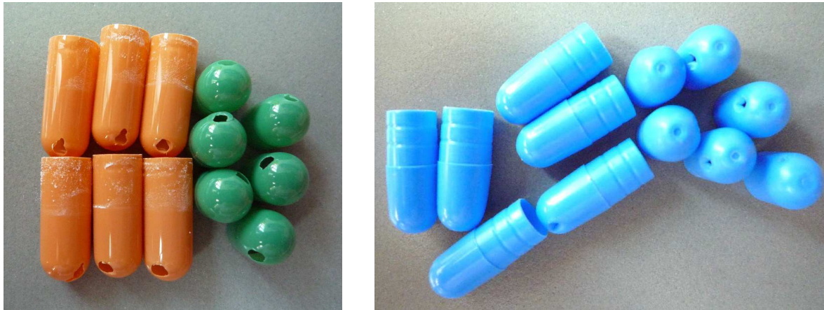
Abbildung 46 Gelatinekapseln (links) und PE-Kapseln (rechts) nach dem Ausbringen der Pulvermischung
