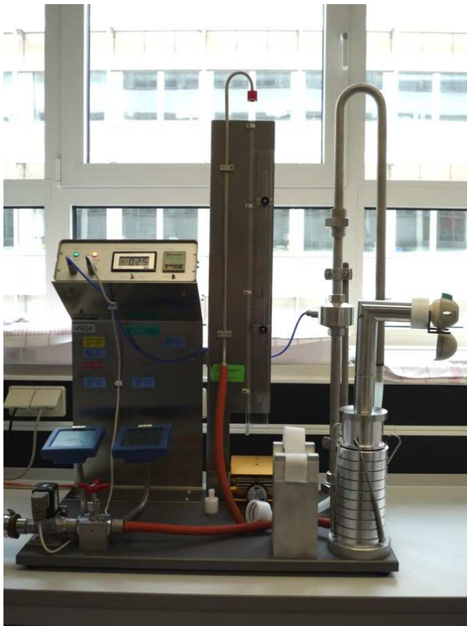
Abbildung 31 Beispiel einer Steuerwand zur Bestimmung der aerodynamischen Partikelverteilung (Modell BI)
