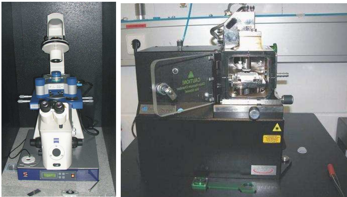
Abbildung 29 links das AFM der Fa. JPK, JPK NanoWizard®, rechts das AFM der Fa. Veeco, EnviroScope (Quelle: www.mpip-mainz.mpg.de )
