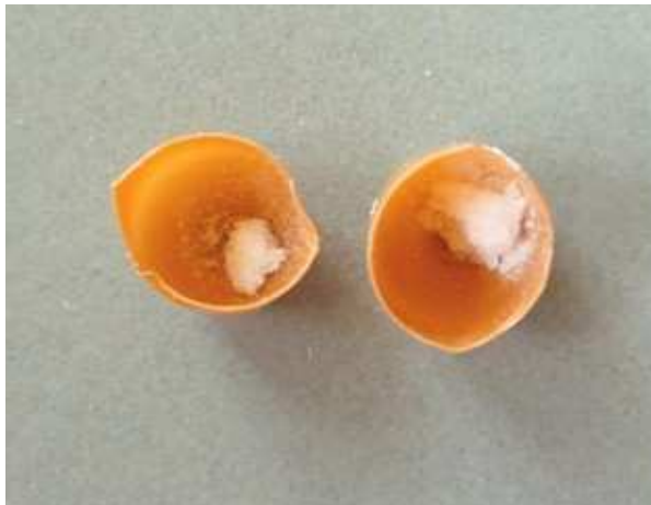
Abbildung 54 Pulverreste der Mannitolmischung im Unterteil der Gelatinekapsel, 6 Monate Lagerung bei extremen Bedingungen in perforierter Blisterverpackung
