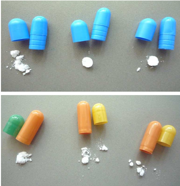
Abbildung 52 Mannitolpulvermischung aus PE-Kapseln oben und Gelatinekapseln unten, 6 Monate Lagerung bei extremen Bedingungen in perforier Blisterverpackung
