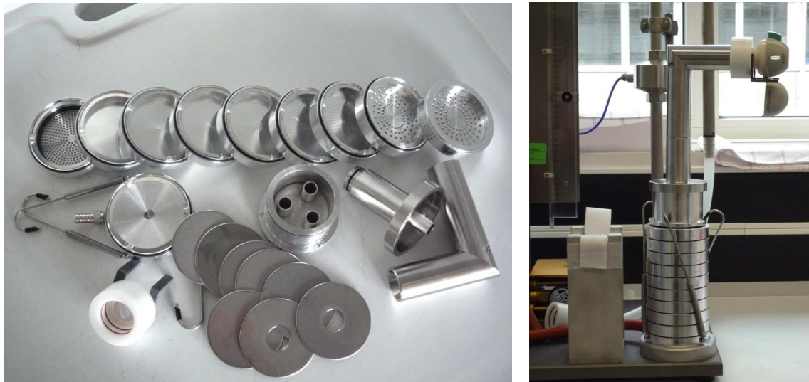
Abbildung 17 Bestandteile des Andersen Kaskadenimpaktors links und ein zusammengesetzter Andersen Kaskadenimpaktor rechts
