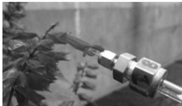
Abbildung 3.8: schematischer Aufbau und Foto der Probenahme mit dem verwendeten Einlasssystem
