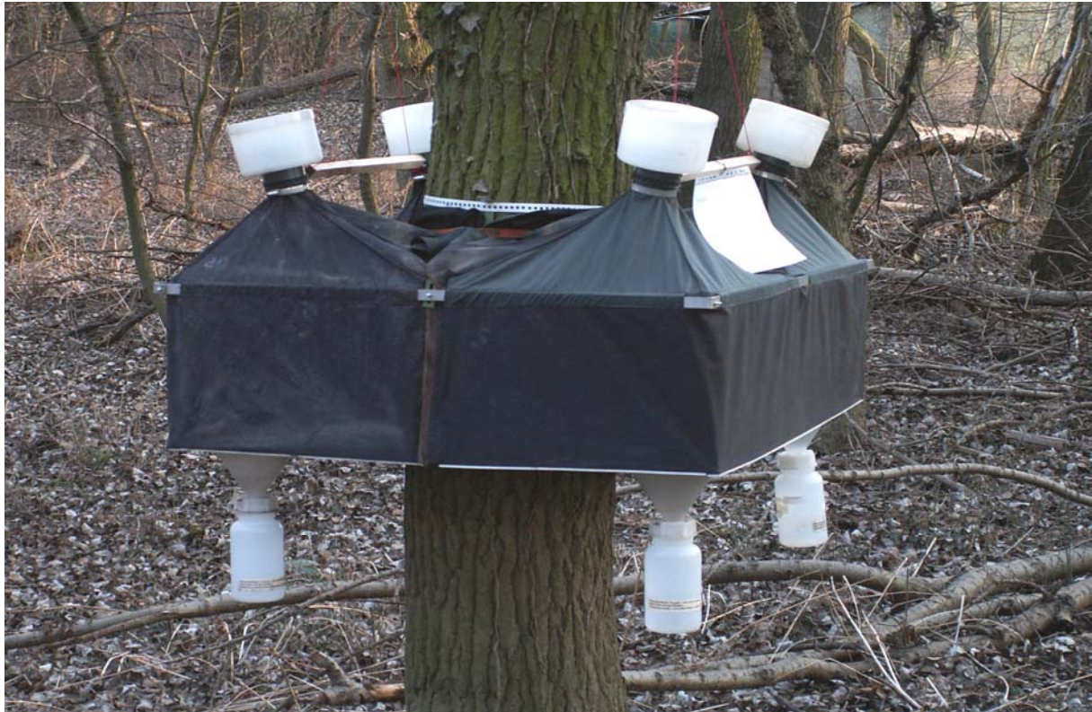
Abb. 48: Stammeklektor im Einsatz
