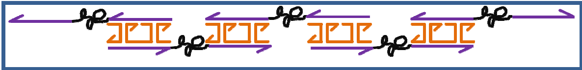
Abb. 5.3: Verknüpfung von Dreiblockcopolymeren über double crossover Strukturen. Zwischen den Kreuzungspunkten muss ein Vielfaches einer halben Helixwindung liegen.
