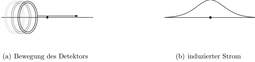
Abbildung 2.3.: Induzierter Strom bei Bewegung eines Detektors mit zwei konzentrischen Spulen entlang einer Linie über ein Objekt.
