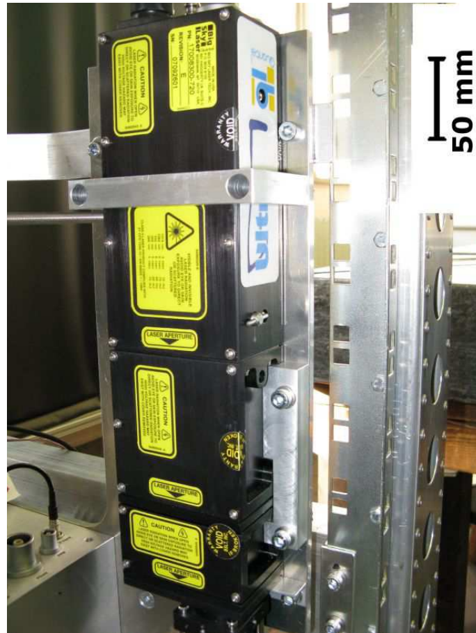
Abbildung 2.12: Montage des Laserkopfes.
