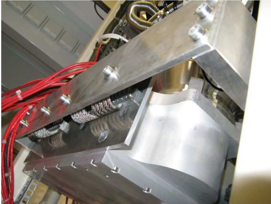
Abbildung 4.4: Montage der Drahtseilfeder-elemente am Massenspektrometer.
