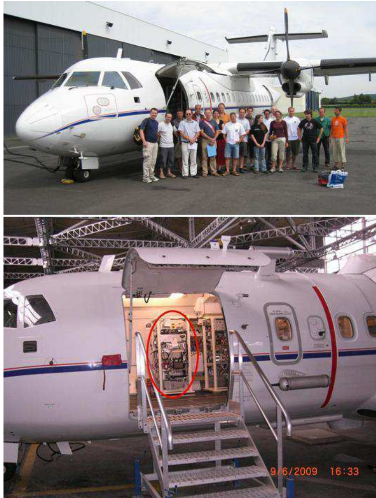
Abbildung 5.3: Messflugzeug ATR-42 und ALABAMA in eingebautem Zustand.
