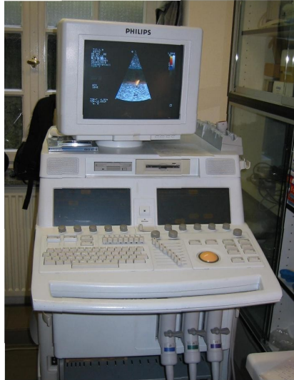
Abbildung 2-11: Farbduplex Ultraschallgerät mit einer Frequenz von 3 MHz Leihgabe der Firma Philips
