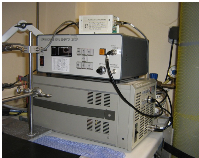
Abbildung 2-10: Schallgeber und Ultraschallgerät 488 kHz-Sonde, Furuhashi/Tokyo/Japan
