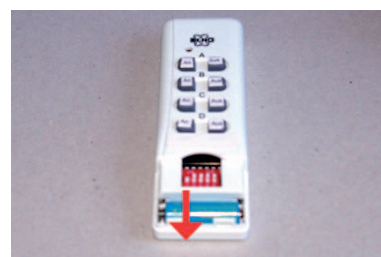
Abb. 14 · Schalter 1 nach unten schieben
