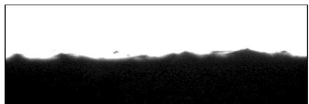
Abbildung 5-13: Enalapril-Preßling (10min O 2 , ideal benetzt)
