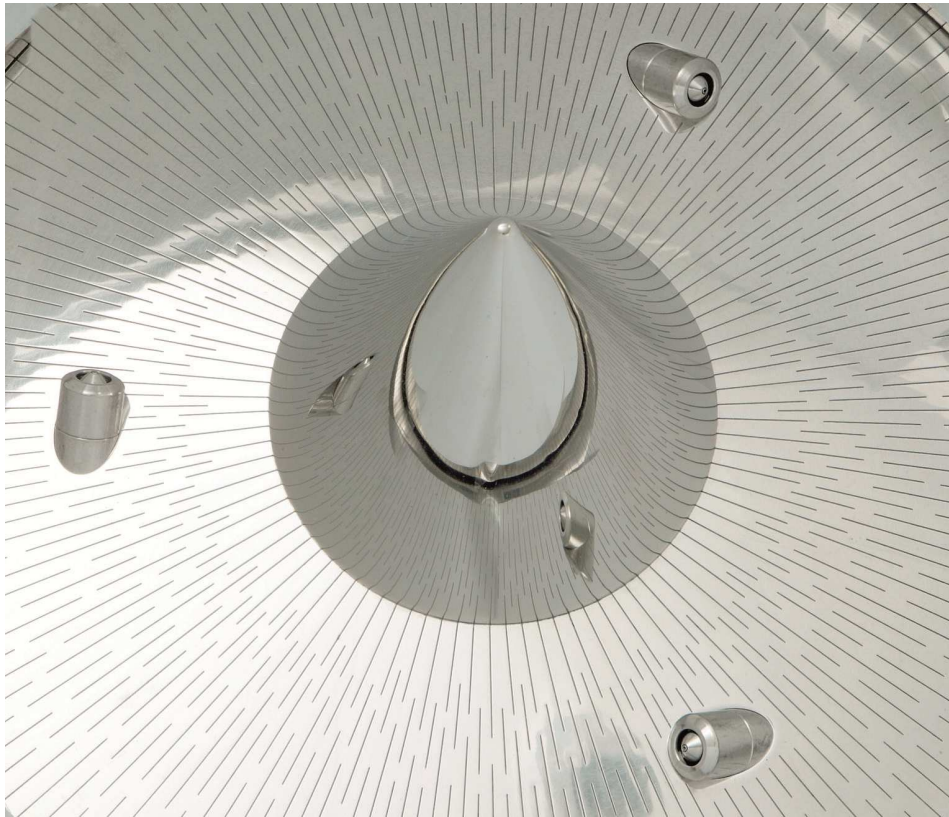
Abbildung 4-4: Prozessgasverteilerboden Diskjet mit eingebauten Dreistoffsprühdüsen (Hüttlin GmbH).
