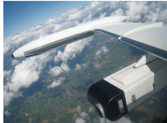
Abb. 27: Flügelbehälter unterhalb des rechten Flügels des Learjets (wurde dem Photopool des AK Harders, MPIC entnommen).
